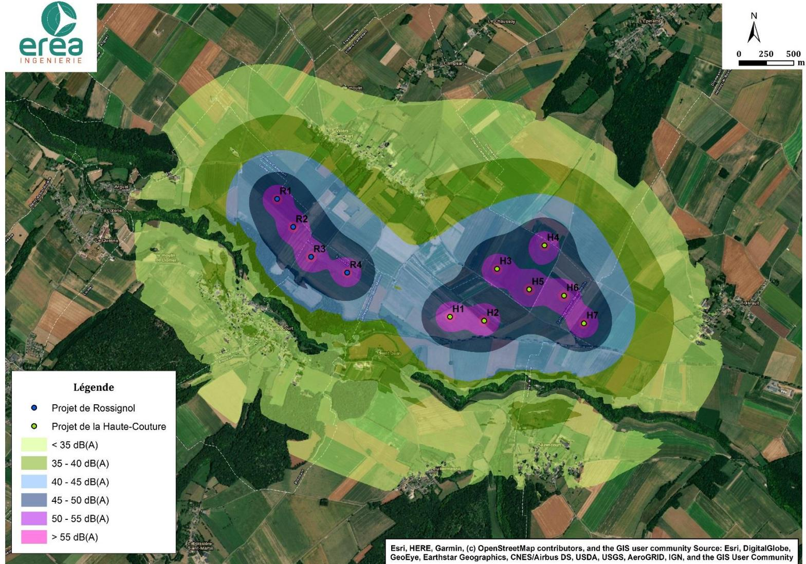
*Isophones à une hauteur de 2 m du sol de la contribution des éoliennes VESTAS V110 2,2 MW pour une vitesse standardisée de 10 m/s et une direction Nord-Est*
